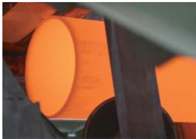
▲ Tubo durante processo de têmpera, primeira fase do Tratamento Térmico.
