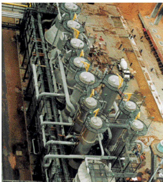
Planta de evaporação de licor negro tipo Falling Film – capacidade de 360 toneladas/hora
