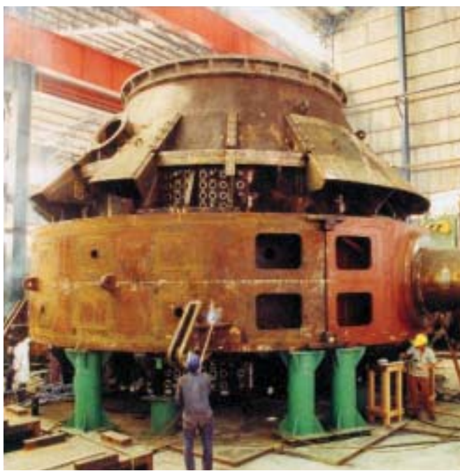
▼ Conversor a oxigênio, capacidade de 220 t de aço líquido.
