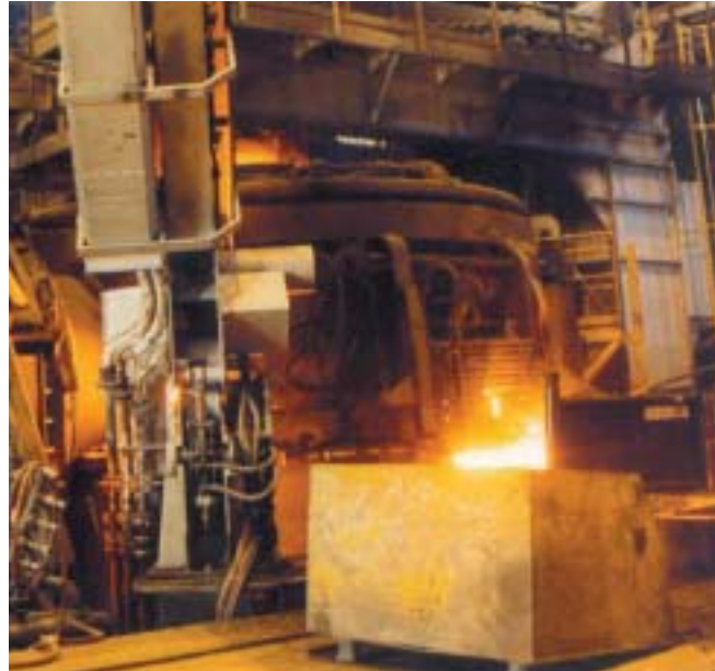
▲ Sistemas de carregamento contínuo e preaquecimento de sucata em fornos elétricos.
