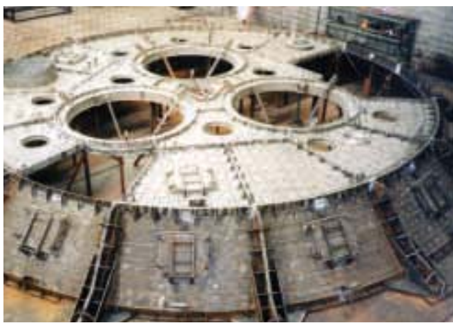
▼ Tampa refrigerada para forno de redução de minérios.
