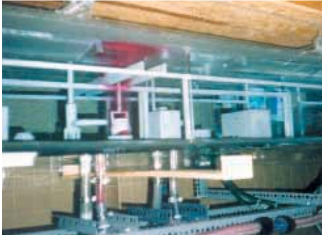
▲ Modelo hidrodinâmico de sistema de despoejamento de aciaria.
