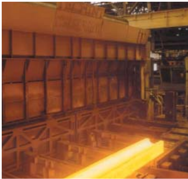
▼ Fornos de reaquecimento e tratamento térmico.
