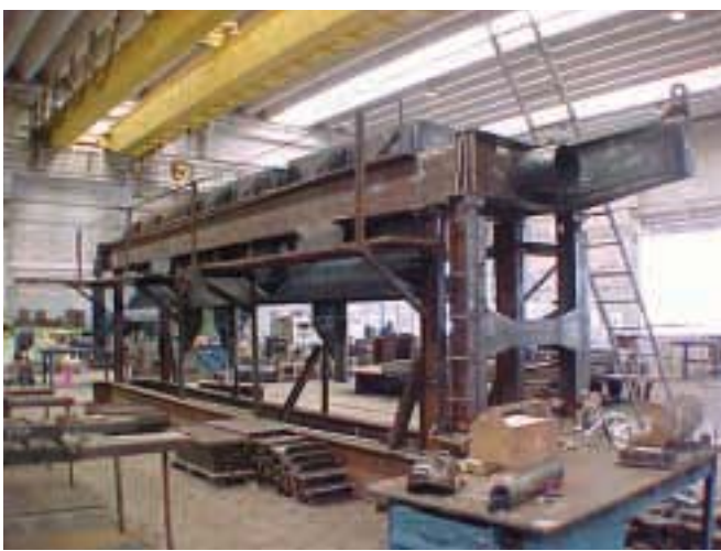
▼ Superestrutura de cuba eletrolítica para a fabricação de alumínio.
