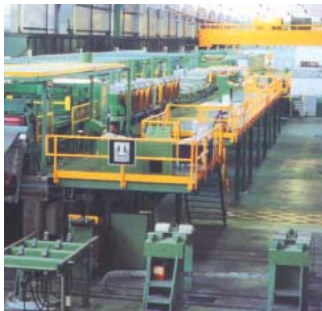
▼ Sistemas de Tratamento de Chapas – decapagem, zincagem, pintura e acabamento.
